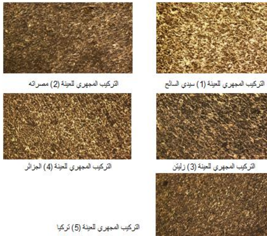
شكل (3) التركيب المجهرى للعينات الخمس بقوة تكبير 20X
